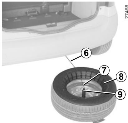
Legen Sie nach einem Radwechsel das ausgebaut Rad mit dem Ventil nach unten auf die Halterung **9**. Je nach Fahrzeug: Bringen Sie das Distanzstück **8** wieder an. Hängen Sie den Seilzug **6** in seine Führung **7** ein und drücken Sie das Rad unter den Gepäckraumboden (Lasche **10** zum Fahrzeugheck).
