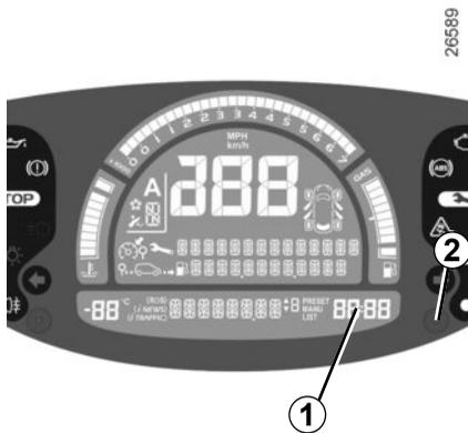
Die Uhrzeit wird bei eingeschalteter Zündung angezeigt.
