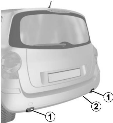
Je nach Ausstattungsniveau besitzt der hintere Stoßfänger zwei Öffnungen mit Befestigungspunkten für den Fahrradträger sowie eine Steckdose **2** unter dem Fahrzeug.
