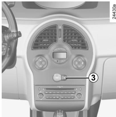
Zur Verriegelung des Fahrzeugs mit einer offenen Tür/Haube/Klappe (Transport von Gegenständen im geöffneten Gepäckraum...) oder wenn es sich in einem Bereich starker elektromagnetischer Strahlung befindet oder bei einer Störung des Schlüssels: Bei ausgeschaltetem Motor länger als fünf Sekunden auf den Knopf **3** drücken.
