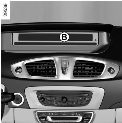
**Instrumententafel A** oder **B**: wird beim Einschalten der Zündung beleuchtet.
