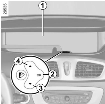
Diese im Bordcomputer **1** integrierte Funktion ermöglicht, je nach Ausrüstung des Fahrzeugs, die Aktivierung/Deaktivierung sowie die Einstellung bestimmter Fahrzeugfunktionen.
