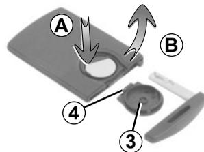
Gehen Sie beim Einsetzen in umgekehrter Reihenfolge vor. Drücken Sie anschließend viermal in Fahrzeughöhe auf eine der Keycard-Tasten: Beim nächsten Startvorgang erscheint die Meldung nicht mehr.
