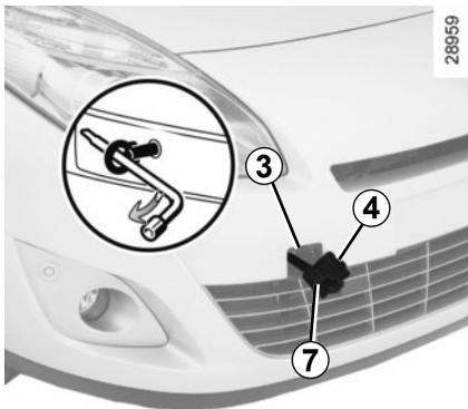
Verwenden Sie zum Abschleppen ausschließlich die Abschleppösen vorne **3** und hinten **5**, keinesfalls aber die Antriebswellen! Die Abschleppösen sind ausschließlich für Belastung durch Zug ausgelegt und dürfen nicht verwendet werden, um das Fahrzeug direkt oder indirekt anzuheben.
