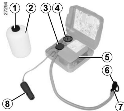
Öffnen Sie das Set, entfernen Sie die Deckel **1** und **3** (hierbei darf **unter keinen Umständen** die Verschlussfolie von der Flasche entfernt werden) und schrauben Sie anschließend die Flasche **2** auf ihre Halterung **3**.
