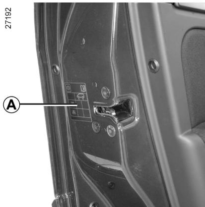
Der Reifendruck ist auf dem Aufkleber **A**, der auf der Fahrertürkante angebracht ist, angegeben. Öffnen Sie die Tür, um die Angaben zu lesen.
