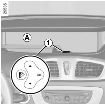
Je nach Fahrzeug verfügen Sie über eine Instrumententafel mit persönlicher Einstellung der Anzeige **A** oder ohne persönliche Einstellung der Anzeige **B**.
