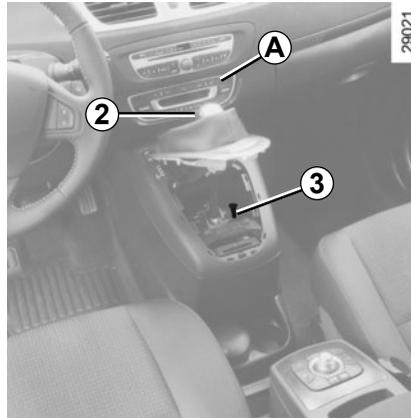
Sollte der Hebel **beim Starten** in Position **P** blockiert sein, auch wenn das Bremspedal betätigt und der Entriegelungsknopf **2** gedrückt wird, kann der Hebel von Hand gelöst werden. Hierzu die Grundplatte des Wahlhebels ausrasten, indem Sie auf der Seite beginnen, die sich unter der Bedieneinheit **A** für die Klimaanlage befindet; drücken auf den Knopf **3** und gleichzeitig auf den Entriegelungsknopf **2** am Wahlhebel.
