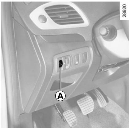
Bei manchen Fahrzeugen kann die Leuchtweite je nach Beladung des Fahrzeugs über die Bedieneinheit **A** eingestellt werden.
