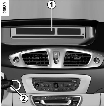
Das System erkennt den Reifendruck. Die Informationen werden (je nach Fahrzeug) an der Instrumententafel angezeigt. In diesem Fall erscheinen Sie:
