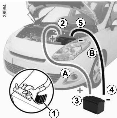
Schließen Sie zuerst das Pluskabel **A** an dem **Socket 1** auf dem Pluspol **2 (+)** und dann am **Pluspol 3 (+)** der Strom gebenden Batterie an.
