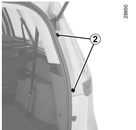
Lösen Sie von außen die Schrauben **2** mit Hilfe eines Schlitzschraubendrehers o. Ä. und ziehen Sie die Leuchteneinheit zu sich.
