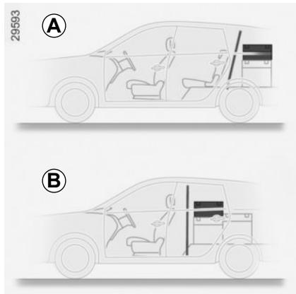
Je nach Fahrzeug ist die Verwendung sinnvoll, um den Gepäckraum vom Fahrgastraum abzutrennen (Transport von Tieren oder Gepäckstücken).
