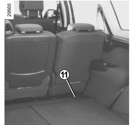
Je nach Fahrzeug müssen die Verzurösen **11** am Laderaumboden entfernt werden, bevor Sie ein Trennnetz anbringen.
