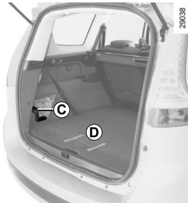
Je nach Fahrzeug ist im Falle einer Reifenpanne das Reparaturset im Ablagefach **C** oder unter der Gepäckraummatte **D** zu verwenden.
