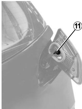
Ziehen Sie die Leuchteneinheit von außen heraus und lösen Sie den Lampenträger **11** um eine Vierteldrehung.
