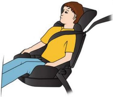
Ab einem Gewicht von 15 kg oder dem Alter von 4 Jahren kann ein Kind auf einer Sitzerhöhung Platz nehmen, die eine Anpassung des Sicherheitsgurts an den Körper des Kindes ermöglicht. Das Sitzkissen der Sitzerhöhung muss Beckengurtführungen aufweisen, damit der Sicherheitsgurt auf den Oberschenkeln und nicht am Bauch des Kindes verläuft. Damit der Gurt über die Mitte der Schulter verläuft, empfehlen wir die Verwendung einer Sitzerhöhung
