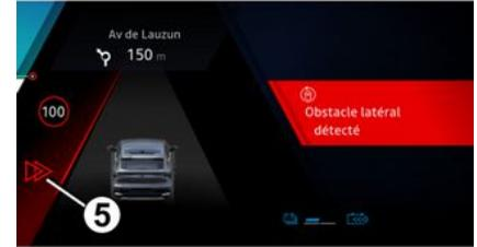
Beim Fahren ab einer Geschwindigkeit von ca. 65 km/h: wenn Sie sich einer (durchgehenden oder unterbrochenen) Linie nähern und die Gefahr eines Zusammenstoßes mit einem Fahrzeug besteht, das sich im toten Winkel **D** befindet und sich in die gleiche Richtung wie Ihr Fahrzeug bewegt, oder mit einem Fahrzeug, das sich auf einer angrenzenden Fahrspur schnell von hinten nähert und sich im Erfassungsbereich **E** befindet, wird das System aktiviert:
