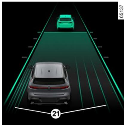
Zum Aktivieren der Position innerhalb der Spur muss sich die „Spurhaltefunktion“ im Einstellmodus befinden, auf den Displays und Anzeigen die grüne Warnlampe **22** eingeblendet sein und die Fahrzeuggeschwindigkeit weniger als 50 km/h betragen.
