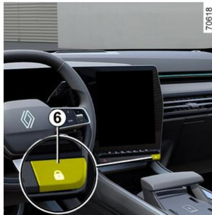
Der Schalter **6** steuert gleichzeitig die Türen, die Gepäckraumklappe und die Kraftstofftankklappe. Wenn eine Tür bzw. die Motorhaube oder Heckklappe geöffnet bzw. nicht korrekt geschlossen ist, werden die Türen/Hauben/Klappen in schneller Folge ver- und wieder entriegelt. Falls Sie einen Gegenstand bei geöffnetem Gepäckraum transportieren, können Sie die anderen Türen trotzdem verriegeln: Halten Sie bei abgestelltem Motor den Schalter **6**, um die Türen/Hauben/Klappen zu verriegeln.
