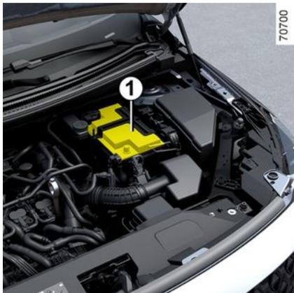
Die Batterie **1** ist wartungsfrei. **Bitte nicht öffnen und keine Flüssigkeit nachfüllen.**
