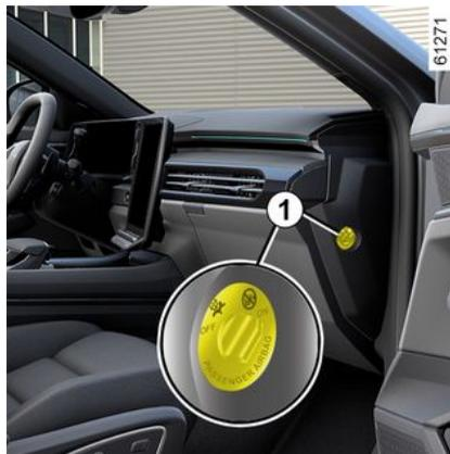
Aktivieren Sie die Beifahrerairbag wieder, sobald Sie den Kindersitz entfernen, um den Schutz des Beifahrers im Falle eines Aufpralls zu gewährleisten.
