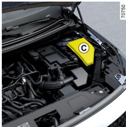
Einige Funktionen sind durch Sicherungen im Motorraum geschützt (Modul **C**).
