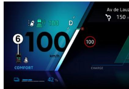
Wenn bei geschlossenen Türen die Zündung eingeschaltet wird, erscheint etwa 60 Sekunden lang die Grafik **6** an der Instrumententafel. Dies informiert den Fahrer jedes Mal über den Anlegestatus der einzelnen vorderen Sicherheitsgurte, wenn:
