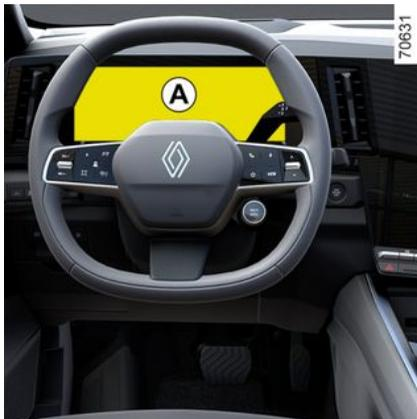
**Instrumententafel A:** Leuchtet auf, wenn die Fahrertür geöffnet wird.
