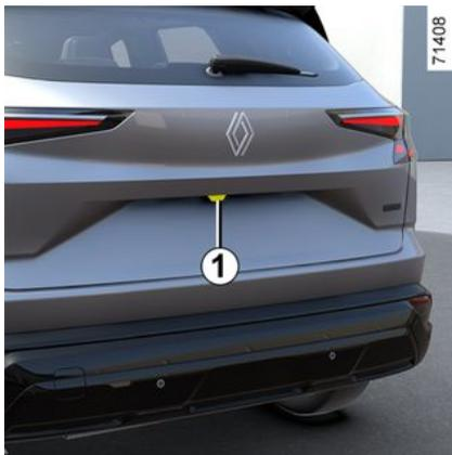
Fährt das Fahrzeug rückwärts, überträgt die Kamera **1** an der Heckklappe die Ansicht des Bereichs hinter dem Fahrzeugheck an das Multimedia-Display **2**, wobei die Anzeige durch eine bis drei Leitlinien **3**, **4** und **5** (feststehende, Mobile und Anhänger-Leitlinien) ergänzt wird.
