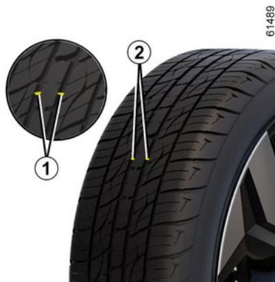
Wenn das Reifenprofil bis zu den Verschleißindikatoren abgenutzt ist, **werden diese sichtbar 2: Dann müssen die Reifen ausgetauscht werden, da die Profiltiefe höchstens 1,6**
