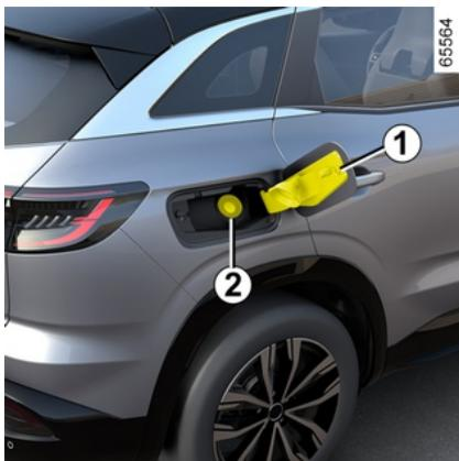
**Unbedingt** bleifreien Kraftstoff verwenden. Die Oktanzahl (RON) muss den Angaben auf dem Aufkleber in der Tankverschlussklappe **1** entsprechen → **432**.
