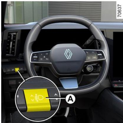
Je nach Fahrzeug kann die Leuchtweiteneinstellung mit dem Schalter **A** an die Ladung angepasst werden.
