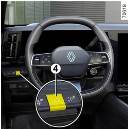
**Zum Öffnen der Heckklappe** halten Sie den Schalter **4** gedrückt, bis das akustische Signal ertönt und lassen dann den Schalter sofort los.
