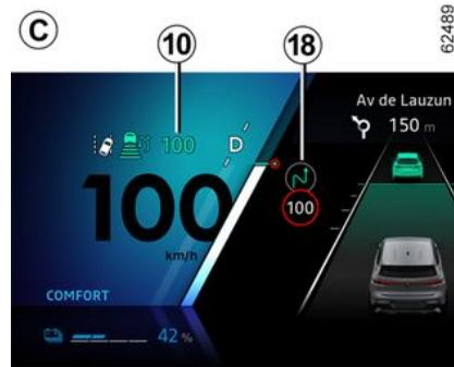
Mithilfe der Kamera, der Funktion „Verkehrszeichenerkennung“ → 252 und der mit dem Abonnement erworbenen Karte kann das System die automatische Anpassung der Fahrgeschwindigkeit **10** vorwegnehmen und verwalten, wenn sich das Fahrzeug einem Kreisverkehr oder einer Kurve nähert.
