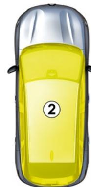
Wenn sich die Karte nach dem Öffnen und Schließen einer Tür **bei laufendem Motor** nicht mehr in der Zone **2** befindet, warnt Sie die Meldung „Karte nicht erkannt“, dass sich die Karte nicht mehr im Fahrzeug befindet. Dadurch kann zum Beispiel ein Wegfahren nach dem Absetzen eines Fahrgasts, welcher die Keycard bei sich trägt, verhindert werden.
