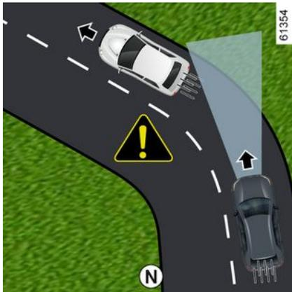
Wenn Sie in eine Kurve einfahren, erkennt das Radar bzw. die Kamera das vorausfahrende Fahrzeug mög-
