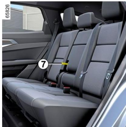
Die mittlere hintere Armlehne **5** herunterklappen oder, je nach Fahrzeug, am Gurt **7** ziehen.
