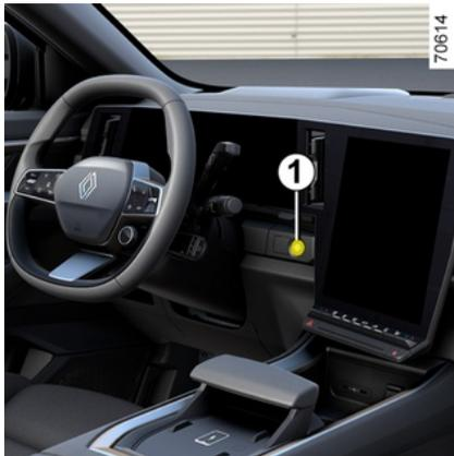
Drücken Sie den Schalter **1**, ohne die Pedale zu betätigen, um die Zündung einzuschalten. Drücken Sie das Bremspedal, und drücken Sie dann den Schalter **3**: Die Kontrolllampe **2** im Schalter und die Kontrolllampe
