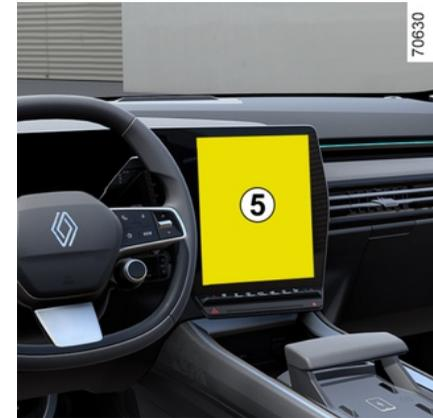
Über das Multimedia-Display können Sie, wenn das „360°-Kamera“-System angezeigt wird, die Ansichten ändern (z. B. Ersetzen Sie die Rückansicht durch die Panorama-Rückansicht).
