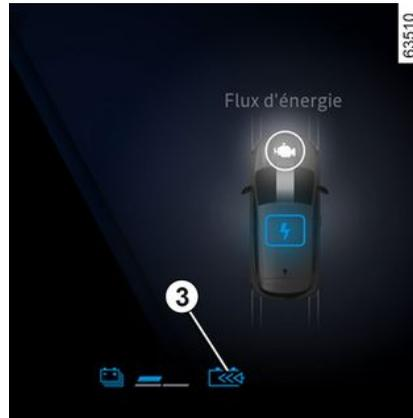
Bei Freigabe des Gaspedals nutzt das Fahrzeug das regenerative Bremsen, um das Fahrzeug zu verlangsamen.
