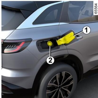
Das Ventil **2** ist in den Einfüllstutzen integriert.
