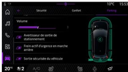
Zum Aktivieren oder Deaktivieren der Funktion wählen Sie in der Umgebung „Fahrzeug“ die Option „Einparkhilfen“ aus. Wählen Sie „Aktive Notbremsung im Rückwärtsgang“.
