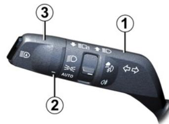
Die Beleuchtung erlischt automatisch, wenn die Fahrertür geöffnet oder das Fahrzeug verriegelt wird, oder eine Minute nach dem Ausschalten des Motors.
