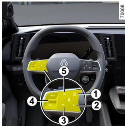
**1.** Schalter zum An-/Abwählen der Fahrhilfen, je nach Fahrzeugausführung:
