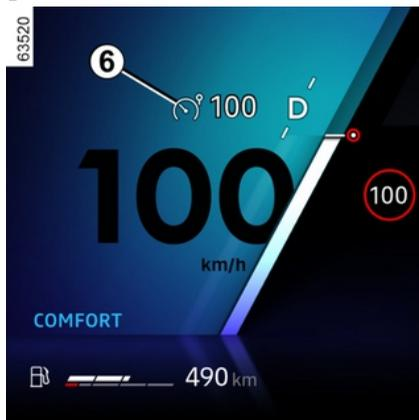
Die **6** Warnlampe leuchtet grau. Die Meldung „Geschwindigkeitsbegrenzung bereit: SET für Aktivierung“ wird in der Instrumententafel zusammen mit Strichen angezeigt, um anzuzeigen, dass die Geschwindigkeitsbegrenzungsfunktion aktiviert ist und auf eine Eingabe einer Geschwindigkeitsbegrenzung wartet.
