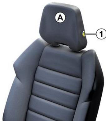
Ziehen Sie die Kopfstütze bis in die gewünschte Position nach oben. Überprüfen Sie die korrekte Verriegelung
