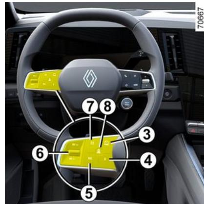
**3.** Schalter zum An-/Abwählen der Fahrhilfen, je nach Fahrzeugausführung:
