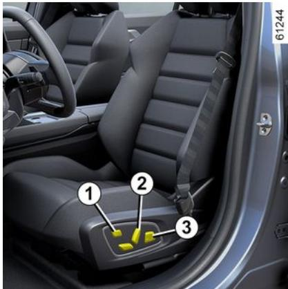
Bei entsprechend ausgestatteten Fahrzeugen kann der Schalter **1** dazu verwendet werden, das Menü „Sitze“ auf dem Multimedia-Display aufzurufen.
