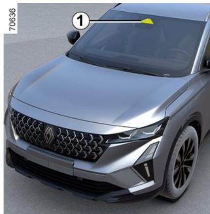
Anhand der Informationen der Kamera **1** löst die Funktion beim Überfahren einer durchgezogenen oder unterbrochenen Linie oder bei Annäherung an den Straßenrand (Spurrenner, Leitplanke, Gehweg, Böschung usw.) eine Korrektur der Fahrzeuglenkung aus, ohne Aktivierung der Fahrtrichtungsanzeiger.
