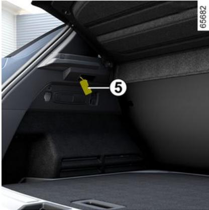
Die Gepäckraumbeleuchtung **5** lösen Sie, indem Sie auf die Lasche an der linken Seite drücken (mit einem Schraubendreher oder ähnlichem).
