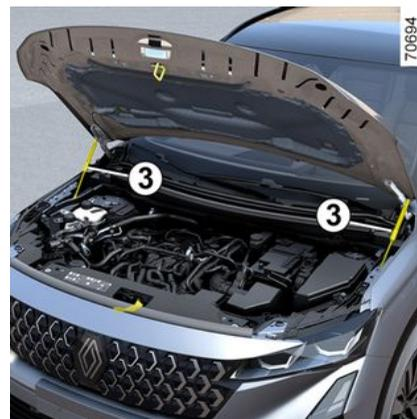
Motorhaube anheben und führen – die Motorhaube wird von zwei Streben gehalten **3**.
