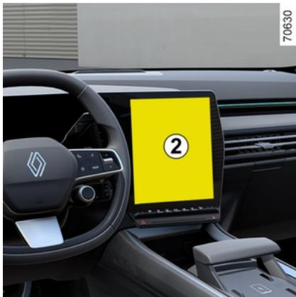
Drücken Sie auf dem Multimedia-Display bei eingelegtem Rückwärtsgang die Schaltfläche „Einstellungen“, um die Leitlinien hinzuzufügen oder zu entfernen und die Kamera-bildeinstellungen (Helligkeit, Kontrast usw.) anzupassen
