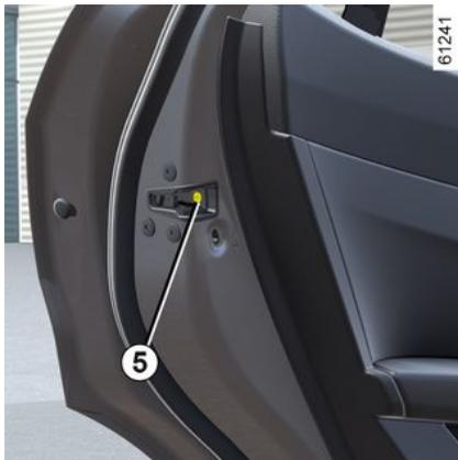
Drehen Sie bei geöffneter Tür die Schraube **5** (mit dem Ende des Schlüssels) und schließen Sie die Tür. Sie ist nun von außen verriegelt. Das Öffnen kann nun nur von innen erfolgen oder mit dem Schlüssel für die Fahrertür.
