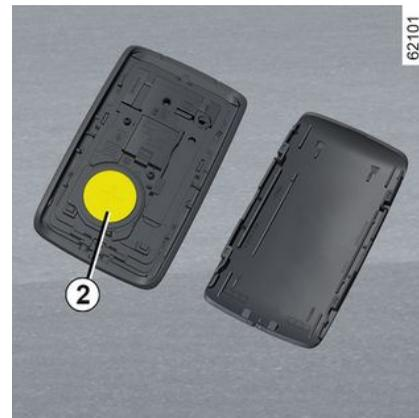
Gehen Sie für den Wiedereinbau in umgekehrter Ausbaureihenfolge vor. Drücken Sie anschließend viermal in Fahrzeugnähe auf eine der Keycard-Tasten: Beim nächsten Startvorgang erscheint die Meldung nicht mehr.
