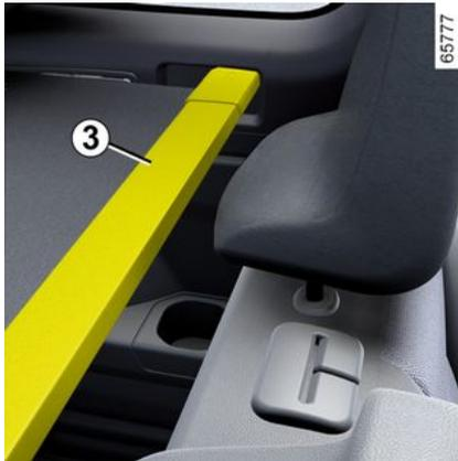
Je nach Fahrzeug ist es notwendig, die Gepäckraumabdeckung **3** so weit wie möglich hinten zu positionieren, um die hinteren Kopfstützen anzuheben/abzusenken.
