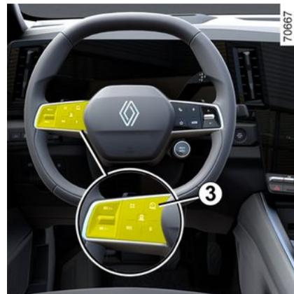
Die Stop and Go-Funktion des adaptiven Tempomaten wird deaktiviert, wenn Sie den Schalter **3** drücken.
